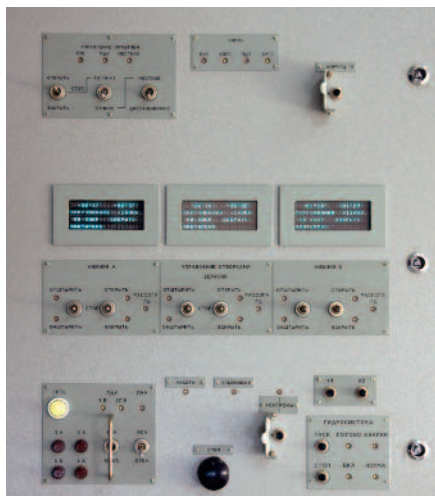
Рис. 8. Пульт дистанционного управления укрытием
